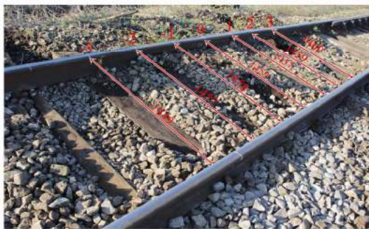
Foto 9: valorile ecartamentului în punctele -3-3
