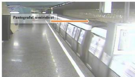
Fotografia 9: Trenul 3901 în stația Gorjului, captură după înregistrările video ale sistemului TV-CI aparținând Metrorex SA. Se observă pantograful în poziția semiridicată la vagonul 3 MP, la TEM 2110.
