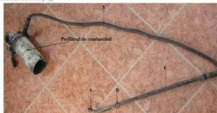
Fig.6 – Filtrul de combustibil și conducta de alimentare cu combustibil
